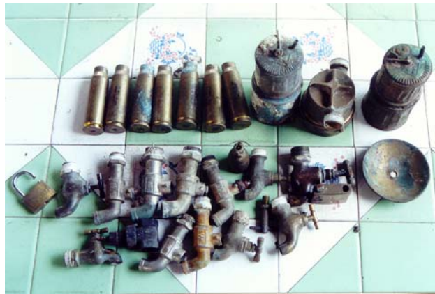
รูปที่ 1 เศษโลหะประเภททองเหลือง ที่นำมาใช้ในการหลอมหล่อ
