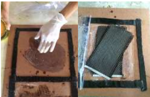
รูปที่ 1 การวางผ้าและติดกาว
