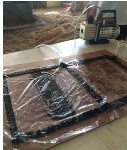
รูปที่ 4 ต่อสายเข้าเครื่องปั๊มลม
