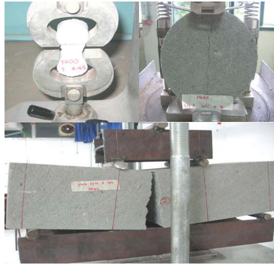
ภาพที่ 1 แสดงการทดสอบกำลังรับแรงดึงโดยตรง กำลังรับแรงดึงผ่าซีก และการทดสอบโมดูลัสแตกร้าว
