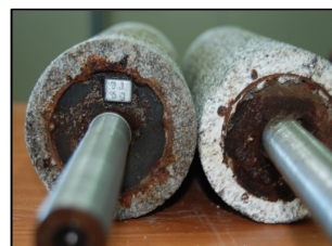
รูปที่ 1 ลูกหินขัดข้าวที่มีการเพิ่มน้ำหนักเพื่อทำให้เกิดการสั่นสะเทือนด้วยตะกั่วถ่วงล้อยนต์
