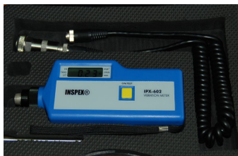
รูปที่ 3 เครื่องวัดแรงสั่นสะเทือน ยี่ห้อ INSPEX รุ่น IPX-602
