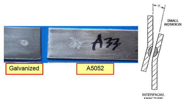
รูปที่ 7 มุมบิตของชิ้นงานทดสอบแรงดึงเหล็กแผ่นกัลวาไนซ์กับอลูมิเนียม เกรด 5052 ที่ค่าแรงกดขึ้นงาน 1,500 นิวตัน (N) กระแสไฟฟ้าที่ใช้ในการเชื่อม 7,000 แอมแปร์ (A) และระยะเวลาในการเชื่อม 11 รอบ (Cycle)
