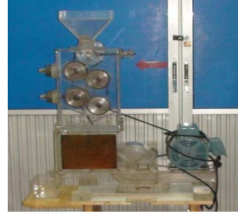
รูปที่ 5 เครื่องกะเทาะข้าวเปลือกขนาดเล็กแบบ 4 ลูกยางที่ทำการออกแบบและสร้าง
