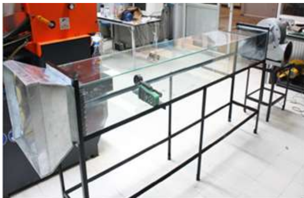
ภาพที่ 2 อุโมงค์ลมจำลองอากาศ (Wind Tunnel) เพื่อใช้ในการทดสอบการทำงานของกังหันลมเพลลาตั้ง
