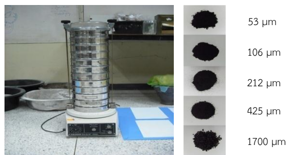
ภาพที่ 2 การคัดแยกขนาดผงถ่านด้วยเครื่อง Vibratory Sieve Shaker ยี่ห้อ FRITSCH รุ่น Vibratory Sieve Shaker Analysette 3
