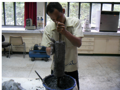
รูปที่ 3 การบันขึ้นรูปโดยพอกหุ้มแกนเหล็กหล่อของลูกหินขัด
