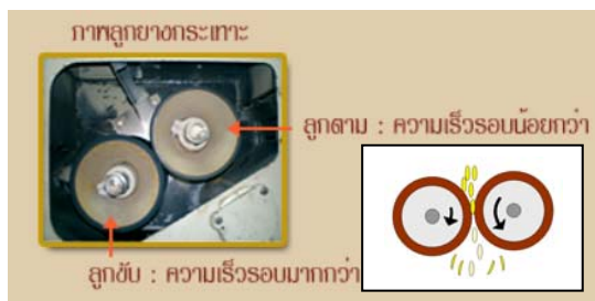
รูปที่ 3 การกะเทาะเปลือกด้วยลูกยาง [1]
