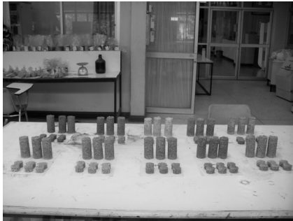
รูปที่ 1 ขั้นตอนทดสอบความต้านทานแรงอัดและความต้านทานแรงดึง
