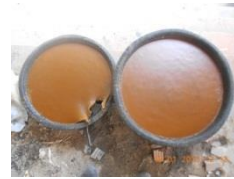
(ฉ) ขี้ผึ้ง ที่ได้จากการผสมเทียน ชันโรง และขี้สูดให้เข้ากัน
