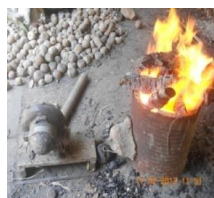
(ฉ) การหลอมขึ้นงาน โดยการไปเผาไฟเป็นเวลา 90 นาที
