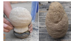
(ซ) เบ้าหุบที่บรรจุโลหะ และเบ้ายัดที่บรรจุหุ่นขี้ผึ้ง นำเบ้าหุบที่บรรจุทองเหลือง มาติดที่บริเวณปากของเบ้ายัด แล้วนำเอาดินเหนียวผสมแกลบมาโอบรอบเบ้าทั้งสอง เพื่อให้เบ้าหุบกับเบ้ายัดยึดติดกัน แล้วนำไปผึ่งแดดทิ้งไว้ 1 วัน
