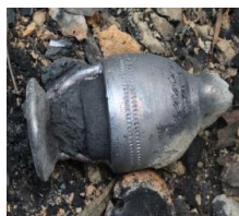
(จ) การแกะแบบ เมื่อน้ำทองเหลืองแข็งตัวแล้ว ทำการทุบเบ้าดินให้แตก นำชิ้นงานที่ได้มาวิเคราะห์หาจุดเสีย และหาความสัมพันธ์ของขนาดของชิ้นงานกับปริมาณและตำแหน่งของทางเข้า
