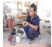
(ข) การอบเบ้ายัด โดยใช้ดินที่ผสมมูลวัว แกลบ และน้ำ มาหุ้มหุ่นที่ทำลวดลายและติดทางเข้าเรียบร้อยแล้วโดยให้ทางเข้าโผล่ออกมา แล้วนำไปตากแดดให้แห้งเป็นเวลา 3-4 วัน
