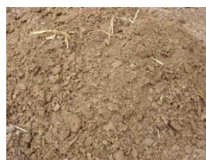
(ข) มูลวัว (ซีวัว) ใช้สำหรับผสมกับดินโพน ปั้นเป็นแม่พิมพ์ ทำให้ดินเกาะตัวแน่นและเพิ่มความโปร่งของเนื้อดิน
