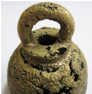
(จ) ระฆังขนาดเส้นผ่านศูนย์กลาง 5 เซนติเมตร ประกอบด้วย 2 ทางเข้า ติดตั้งไว้ตรงปลายฐานระฆัง
