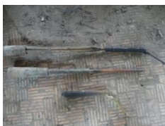
(ฌ) บั้งเตี้ยก ใช้เพื่อฉีดขี้ผึ้งเหลวให้ออกมาเป็นเส้น
