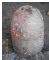
(ฎ) พลิกชิ้นงาน เพื่อให้น้ำทองเหลืองหลอมเหลวไหลลงในโพรง ปล่อยทิ้งไว้ตามธรรมชาติประมาณ 15 นาที
