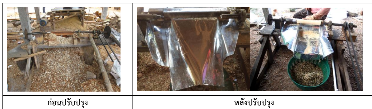
รูปที่ 7 การปรับปรุงระบบกำจัดเศษชี้เลื้อยจากการกลึง
