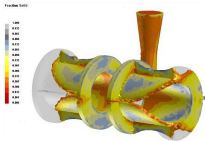
รูปที่ 10 พฤติกรรมการไหลที่ก่อให้เกิดจุดเสียหล่อไม่เต็มแบบ และชิ้นงานเย็นตัวไม่ประสาน
