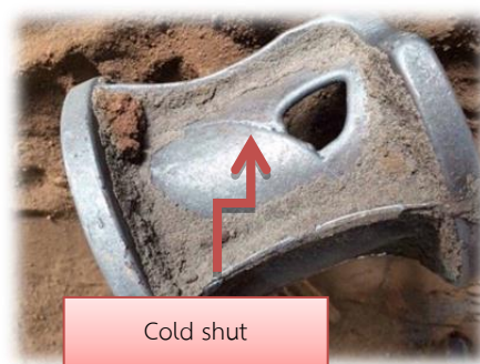
รูปที่ 1 จุดเสียชิ้นงานไม่เต็มแบบ และชิ้นงานเย็นตัวไม่ประสานบนชิ้นงานดุมล้อรถไถนา
