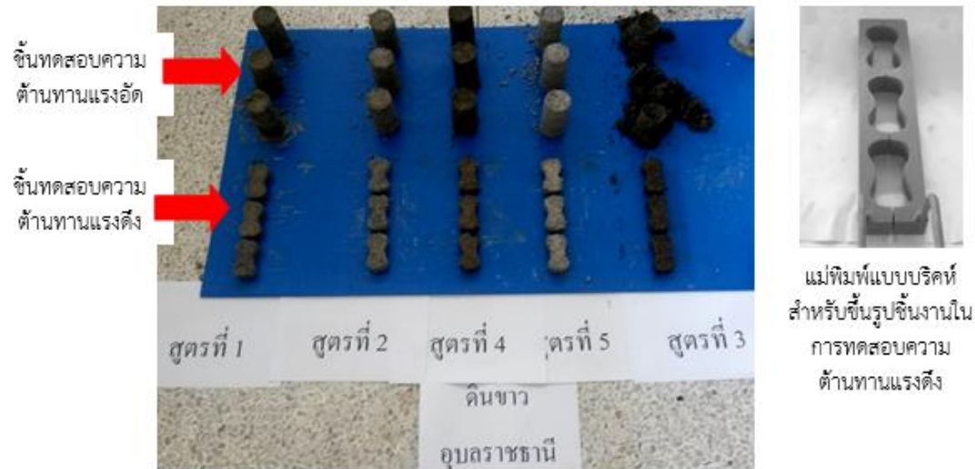
รูปที่ 1 ลักษณะชั้นทดสอบความต้านทานแรงอัดและความต้านทานแรงดึง
